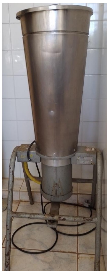
Figura 16 - Liquidificador industrial com capacidade de processar 24 litros.
